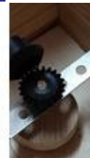
Μηχανισμός με γρανάζια για Ανεμόμυλο
